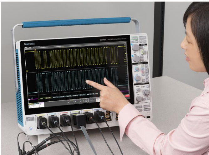
Das kapazitive Touch-Display können Sie genauso bedienen, wie Sie es von Ihrem Smartphone oder Tablet gewohnt sind.
