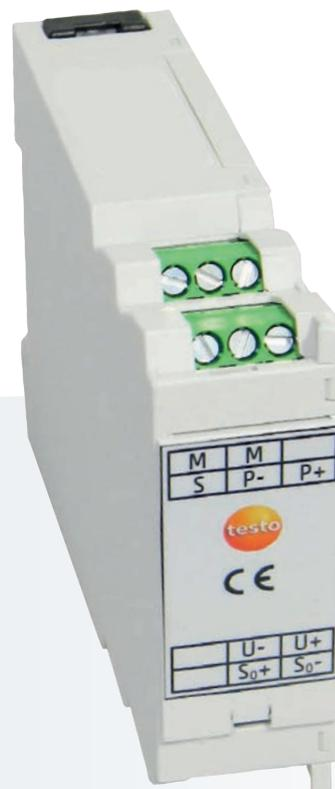
Der 1-kanalige Impulsadapter ermöglicht den Anschluß von Messgeräten mit Kontaktausgang an ein M-Bus System und bietet damit eine einfache und flexible Lösung zum Auslesen bereits installierter Zähler und Messgeräte wie zum Beispiel Druckluftzähler.
